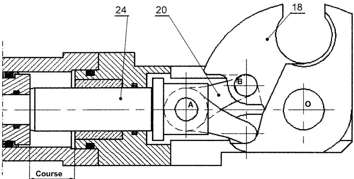
Une mauvaise position des contacts de fin de course peut provoquer un déplacement insuffisant de l'axe du vérin et donc une rotation insuffisante des couteaux. Il faut alors vérifier la position de A et C. La distance (d) entre A et C doit être comprise :  $30 < d < \text{course} = 40$ .
